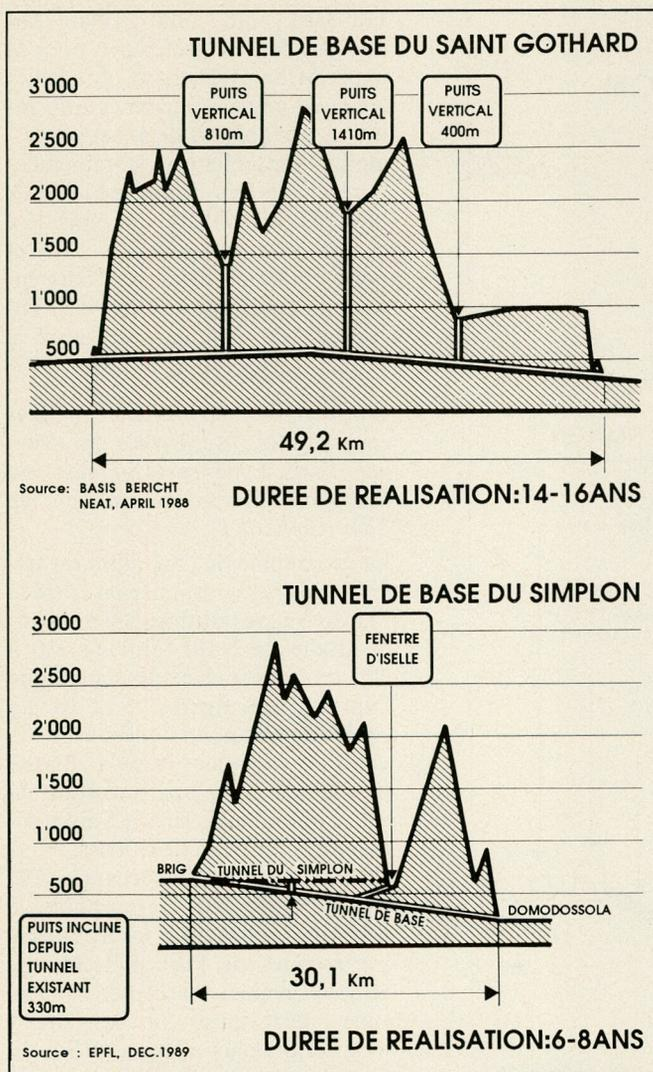
Fig. 13. — Caractéristiques et contraintes de percement des tunnels de base du Saint-Gothard et du Simplon. Tirant parti du tunnel actuel, le tunnel de base du Simplon peut être construit sans avoir recours aux gigantesques puits verticaux proposés pour le percement du tunnel de base du Saint-Gothard selon les documents mis en consultation fédérale. Les coûts et les délais de réalisation seraient considérablement réduits pour le tunnel du Simplon.
